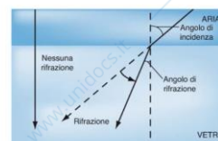
Figura 5-26 Rifrazione di un raggio luminoso al passaggio tra due mezzi di trasmissione con diversa densità ottica.
