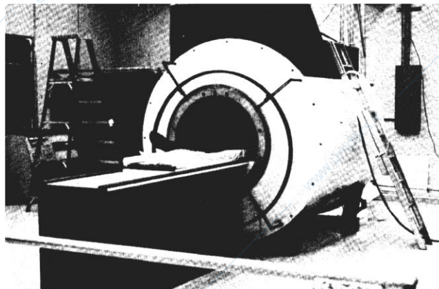
Fig.4.4: apparecchiatura dotata di elettromagnete superconduttivo.
