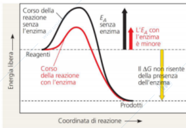
Figura 8.14 Effetto di un enzima sull'energia di attivazione. Senza modificare il valore della variazione di energia libera ( \Delta G ) della reazione, un enzima accelera la reazione stessa riducendone l'energia di attivazione ( E_A ).
