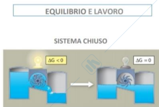
Figura 8.7 Equilibrio e lavoro in un sistema idroelettrico isolato. Il flusso dell'acqua a valle è in grado di far girare una turbina che alimenta un generatore che fornisce elettricità a una lampadina, ma solo fino al raggiungimento dell'equilibrio del sistema.
