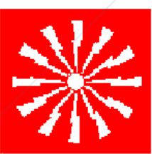
PULSANTE DI ALLARME ANTINCENDIO
