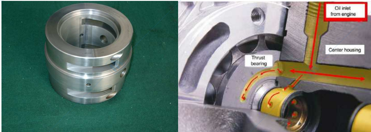
Figura 50 Principali tipologie di cuscini fluidodinamici a olio
