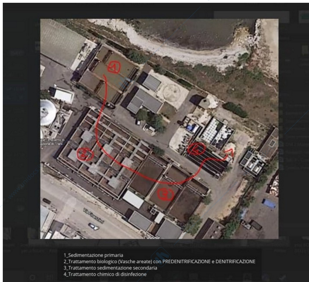
- Percorso del refluo nelle varie vasche dell' impianto di depurazione
