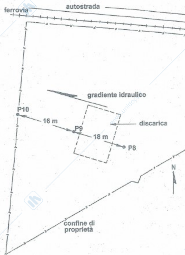
Ubicazione discarica e piezometri di controllo
