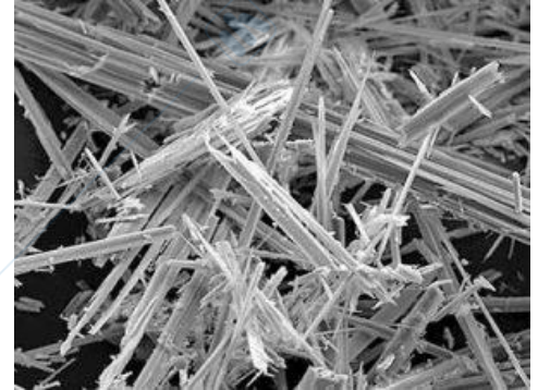
Fibre di amianto
