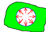
Le forze sostituiscono il fluido rimosso e sono perpendicolari alla superficie in ogni punto
