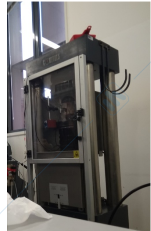
Fig 2: macchina per la prova monoassiale
