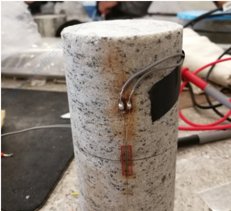
Fig 1: provino con attaccati gli Strain Gauges
