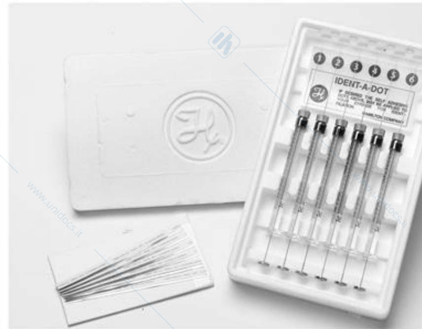
FIGURA 27-3 Un set di microsiringhe per l'iniezione dei campioni. (Per cortesia della Hamilton Company).
