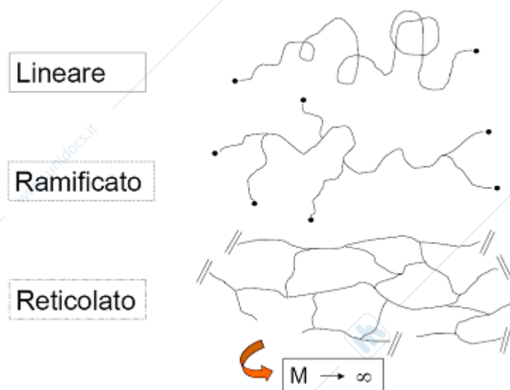
Figura 1. Possibili architetture molecolari dei polimeri
