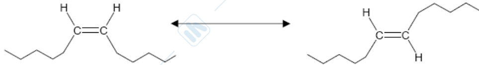
Figura 11. Esempio delle configurazioni cis (sinistra) e trans (destra) nei C sp^2 di doppi legami.
