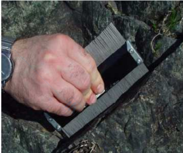
Rilievo di profili tramite il pettine di Barton
