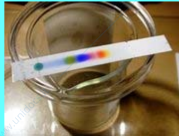
Separazione dei componenti di una goccia di inchiostro nero per TLC (THIN LAYER CHROMATOGRAPHY)
