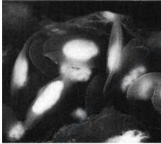
Parti con atomi più pesanti all'interno di una matrice costituita da atomi più leggeri
