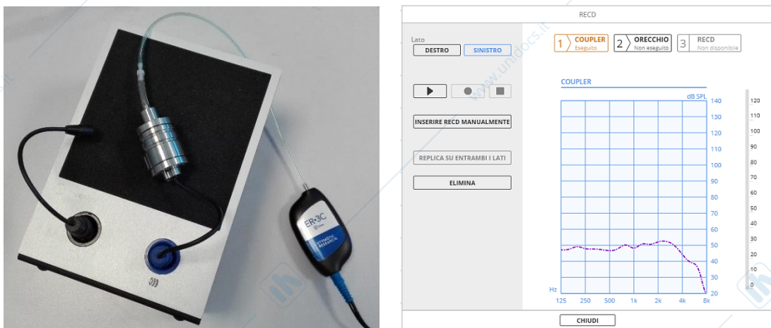
Figura 5.5 Setup per l'acquisizione della risposta in accoppiatore HA-2 (a sinistra) e curva ottenuta registrando la risposta del microfono (a destra, curva viola tratteggiata).
