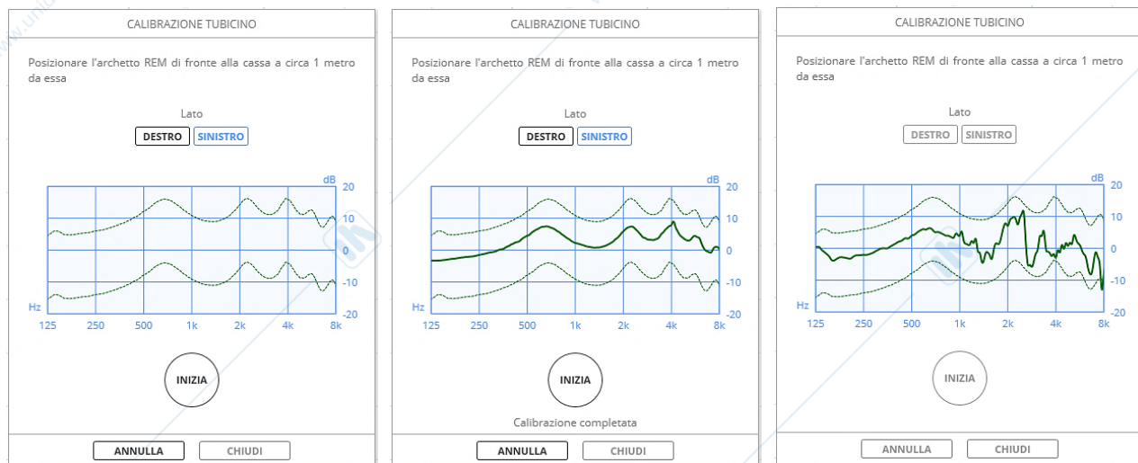
Figura 4.5 Esempio di procedura di calibrazione del tubicino sinistro: il software suggerisce come posizionare i microfoni (immagine a sinistra). Dopo aver dato inizio all'operazione, la curva ottenuta mostra se la calibrazione ha fatto registrare un segnale entro i limiti richiesti (figura al centro) o se la misura non è accettabile (figura a destra).
