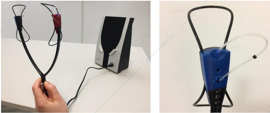
Figura 4.4 Esempio di corretto posizionamento delle sonde rispetto all'altoparlante (immagine a sinistra) e del tubicino sonda in fase di calibrazione (immagine a destra): la ghiera aiuta fissare il tubicino, in modo che sia facile mantenere vicini i due microfoni.
