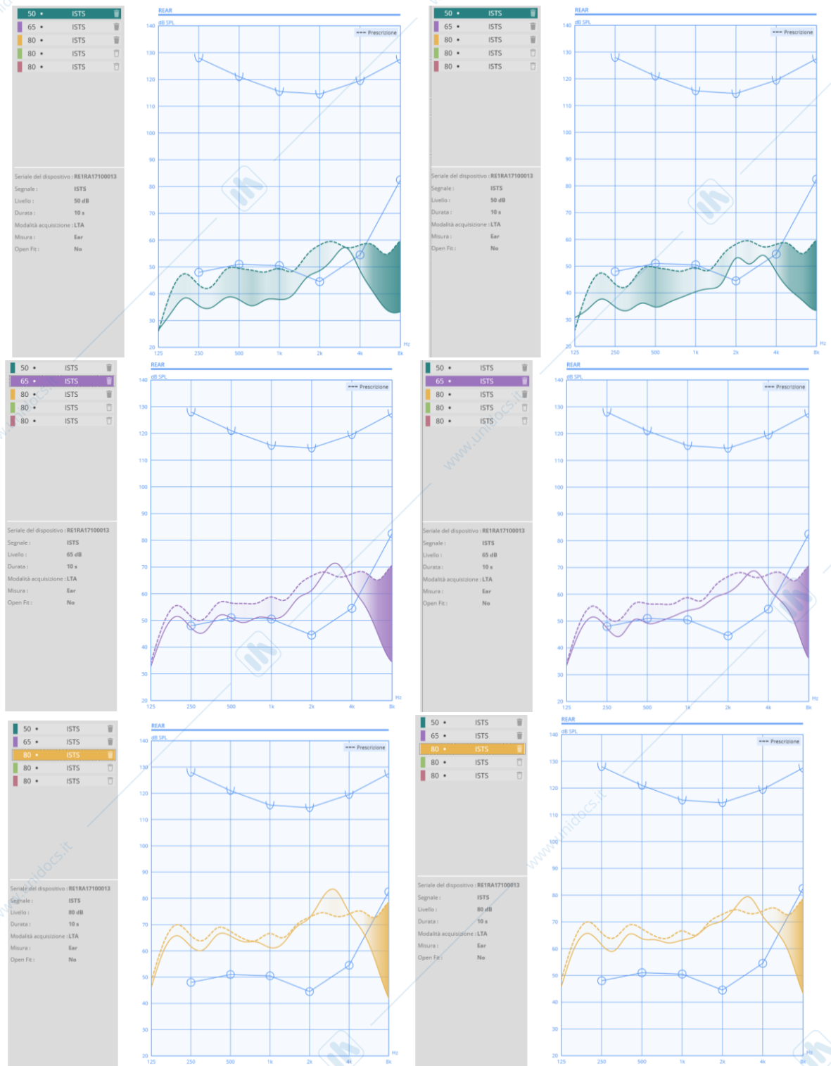
Figura 4.25 Misure REAR (curve continue) sovrapposte alle relative curve target (curve tratteggiate) ottenute prima (grafici di sinistra) e dopo (grafici di destra) aver regolato i guadagni su una paziente che aveva chiesto di sostituire le cupolette standard con delle chioccioline morbide su misura.
