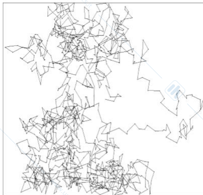
Traiettoria simulata al computer di una particella di gas in 160 nanosecondi 10^{10} urti per molecola per secondo
